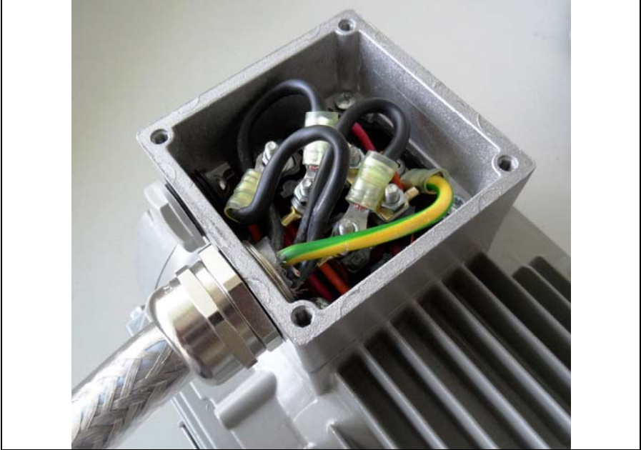
Abb. 11: Verdrahtung am Motoranschlusskasten
