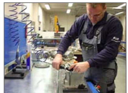
Gehäuse und Deckel werden montiert
