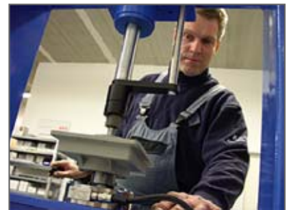
Aufpressen der Zahnradstufe
