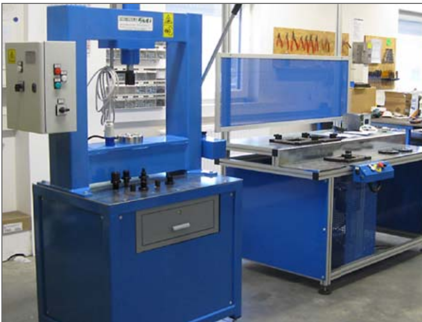
SPS-gesteuerte Montagebank mit Presse, Dichtigkeitsprüfung und Probelaufvorrichtung
