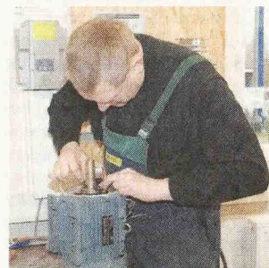
Elektromaschinenbauer Michael Voss baut einen Motor nach den Erfordernissen eines Kunden um. Fotos: Huhndorf (2)/LL
